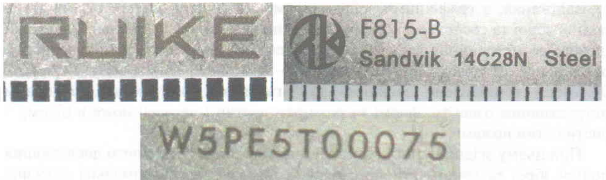
Зображення 4. Збільшене зображення маркувальних позначень на клинку.
